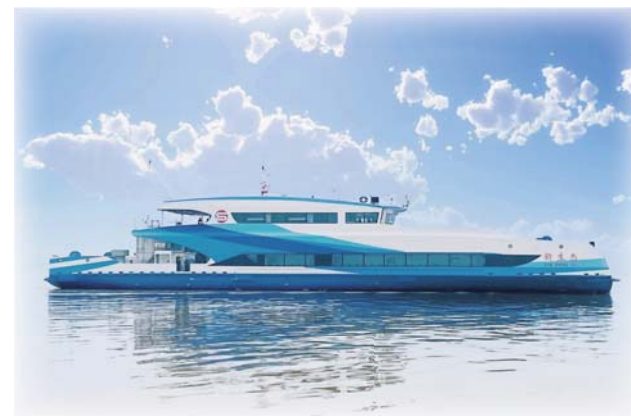
世界首艘超级电容动力渡船“新生态”号
