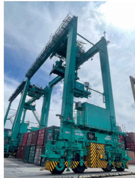
振华重工自主研发的全球首台氢燃料电池轮胎吊。
