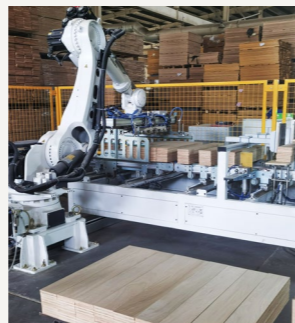
▲ 居住工厂下料机器人码垛
