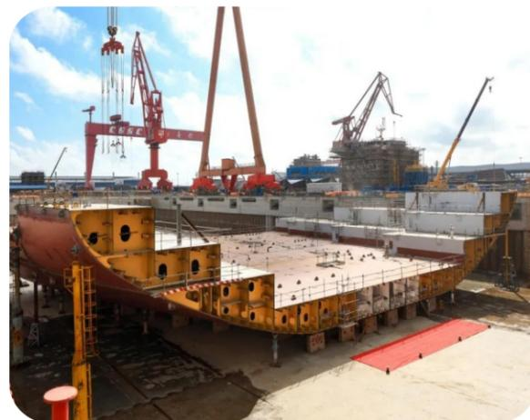
7月22日，中国船舶旗下沪东中华承建的全球最大24000TEU集装箱船首个大型总段“入驻”长兴岛最长船坞，搭载总组进入新阶段。这标志着中船九院承接的沪东中华长兴造船基地1号船坞的主体接长改造工程取得圆满成功并正式投入使用，进一步提升了超大型箱船建造“硬核”能力。
