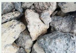
混凝土固体废弃物
