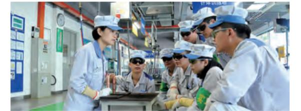
师傅常说，在钎焊操作中，“人”的灵活性是设备操作所无法比拟的。钎焊温度的变化、颜色的变化都要观察，加焊材的时机很重要，一点偏差都可能造成产品上的瑕疵。通过眼脑及经验的综合判断，她谨记师傅的话，不断重复练习着复杂作业条件下的钎焊操作。
