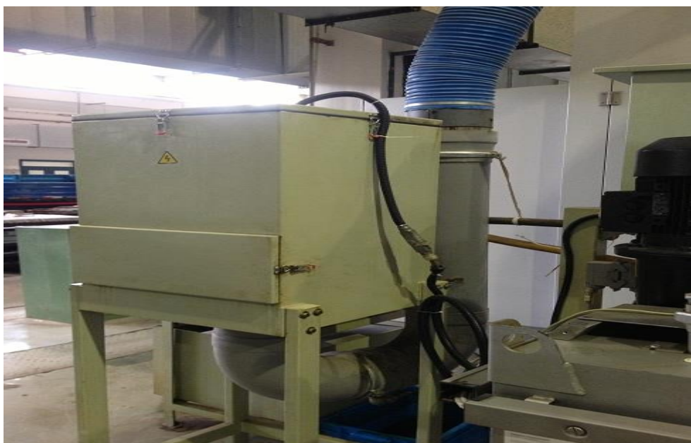
机床上更新的油雾净化装置
