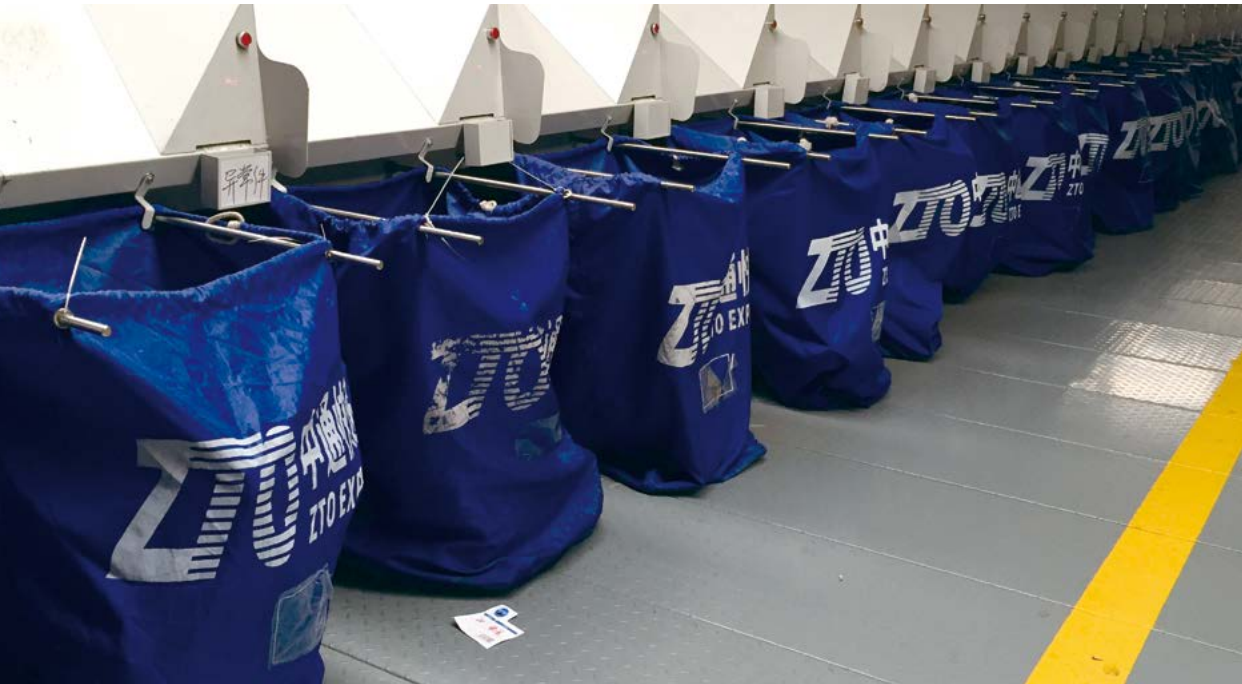
带有 RFID 芯片的可循环集包袋
