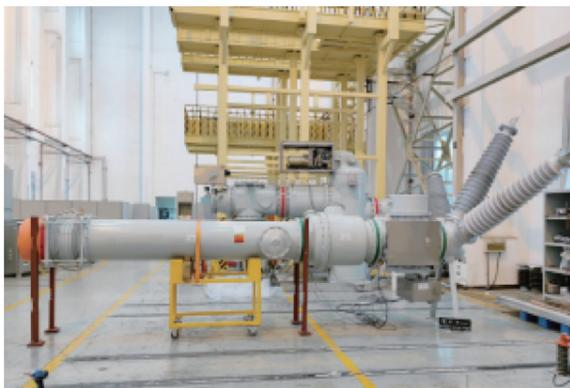
22年公司研发126kV/3150A-40kA混合气体GIS项目,除断路器模块仍采用纯SF<sub>6</sub>气体进行绝缘外,其余模块的绝缘全部采用混合气体,用混合气体替代纯SF<sub>6</sub>气体,相比原来SF<sub>6</sub>气体GIS可减少约50%以上的SF<sub>6</sub>用量,也可起到很好的环保效果,并可显著降低SF<sub>6</sub>使用量和泄漏,减少温室气体的危害,对国家节能减排具有重要意义。
