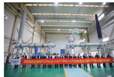
ZFW34-550/Y5000-63型气体绝缘金属封闭开关设备顺利通过西安高压电器研究所全部型式试验，其中断路器电寿命（24次）、机械寿命和局部放电等试验参数均高于国家标准；隔离开关母线转换电流（3000A/435V）、快速接地开关开合电磁感应电流（750A/50kV）及静电感应电流（100A/75kV）等试验参数均达到最新国家标准。
