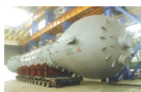
首台大型出口化工容器 (三菱聚丙烯反应器)
