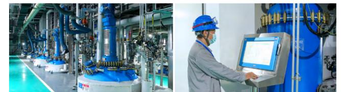
**节能降耗方面:**生产车间设备的用电是最大的能耗单位, 基于设备不同工艺步骤的负荷, 对电机、风机等能耗设备均采用变频电机, 实现降低能耗和最佳的能耗比 (COP)。
