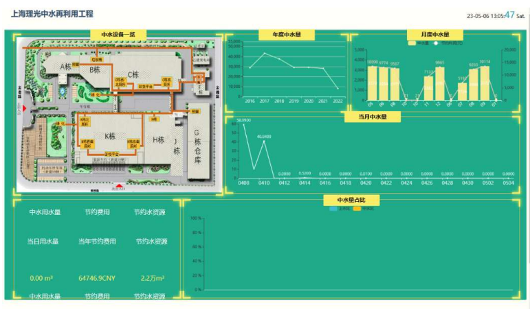
上海理光中水再利用监控系统
