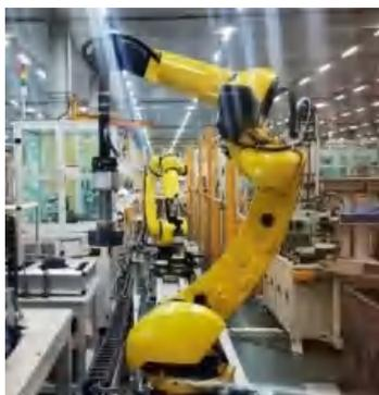
2023年2月20日，南昌海立最大规格16HP变频压缩机电机绕线自动生产线顺利投产。该产线首次尝试将“AGV小车自动配送”“3D相机测距成相技术”“地轨双机器人自动跑位抓取”三套系统完美结合，实现上料、氩弧焊接等9个工序段无人化管理，整线工序自动化率高达70%，人均单台产出提升50%，产品质量得到进一步提升。
