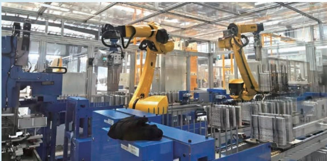
蒸发器管片自动化组装线
