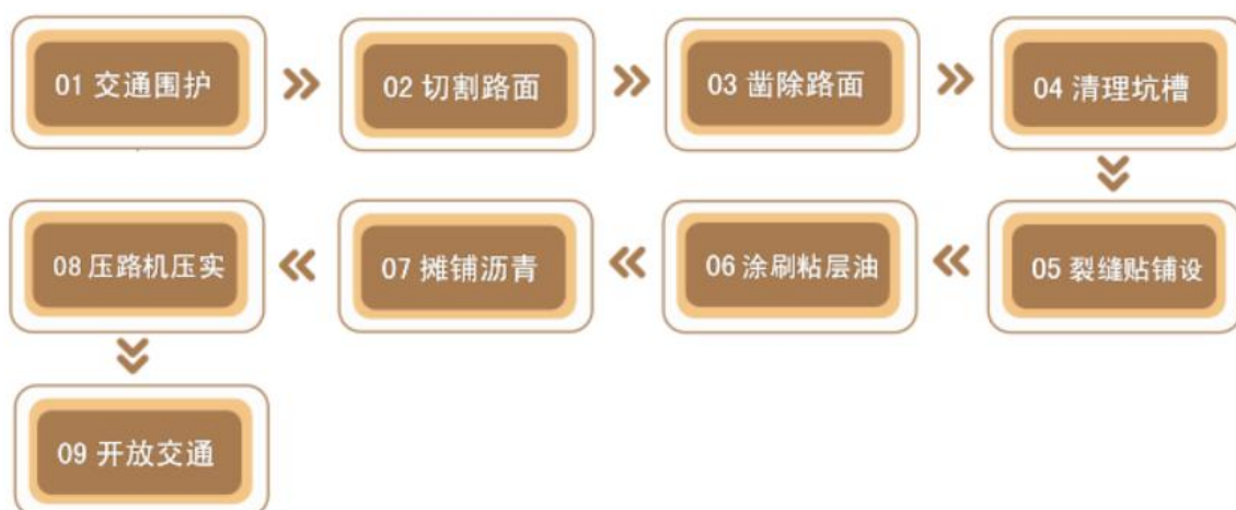
沥青路面坑塘维修
