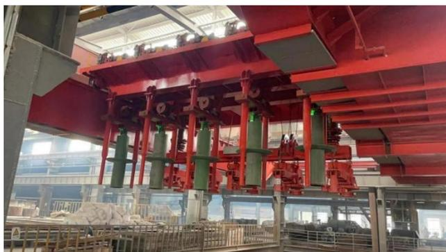
重载桁架机器人
