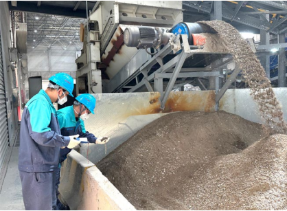
老港处置实现建筑渣土筛分和灰土制免烧砖等建筑渣土资源化综合利用技术
